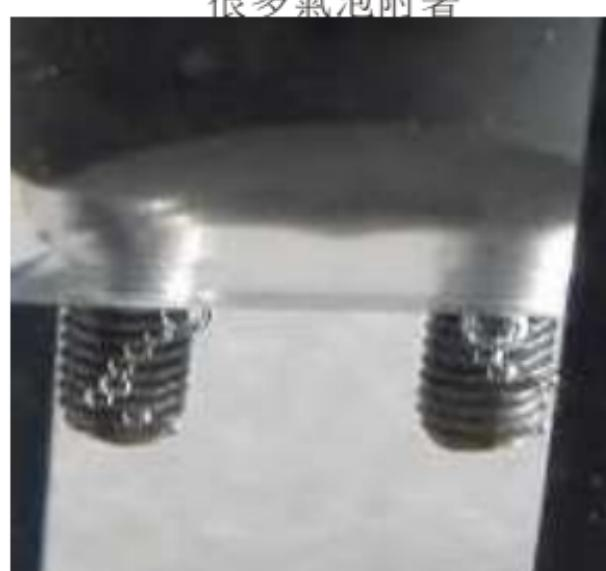
減少氣泡的放法：短暫的將電極浸潤入溶液中，並拿出用掉氣泡。
